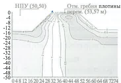
Рис. 3. Температурное поле грунтов плотины после 10 лет эксплуатации при расчете без учета фильтрационного потока
