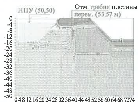
Рис. 2. Температурное поле грунтов плотины (начало расчета)
