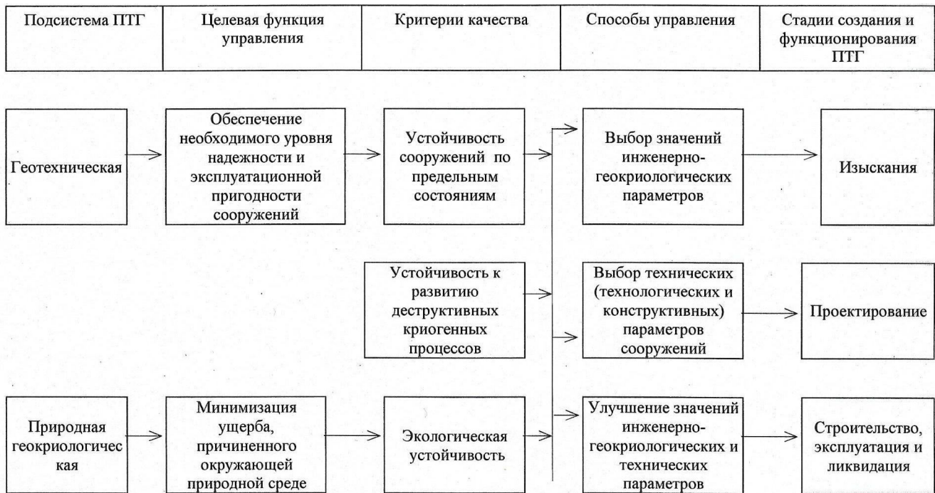
Рис. 2. Принципиальная схема управления природно-техническими геосистемами
